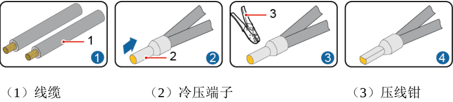
图4-12 制作冷压端子 2
